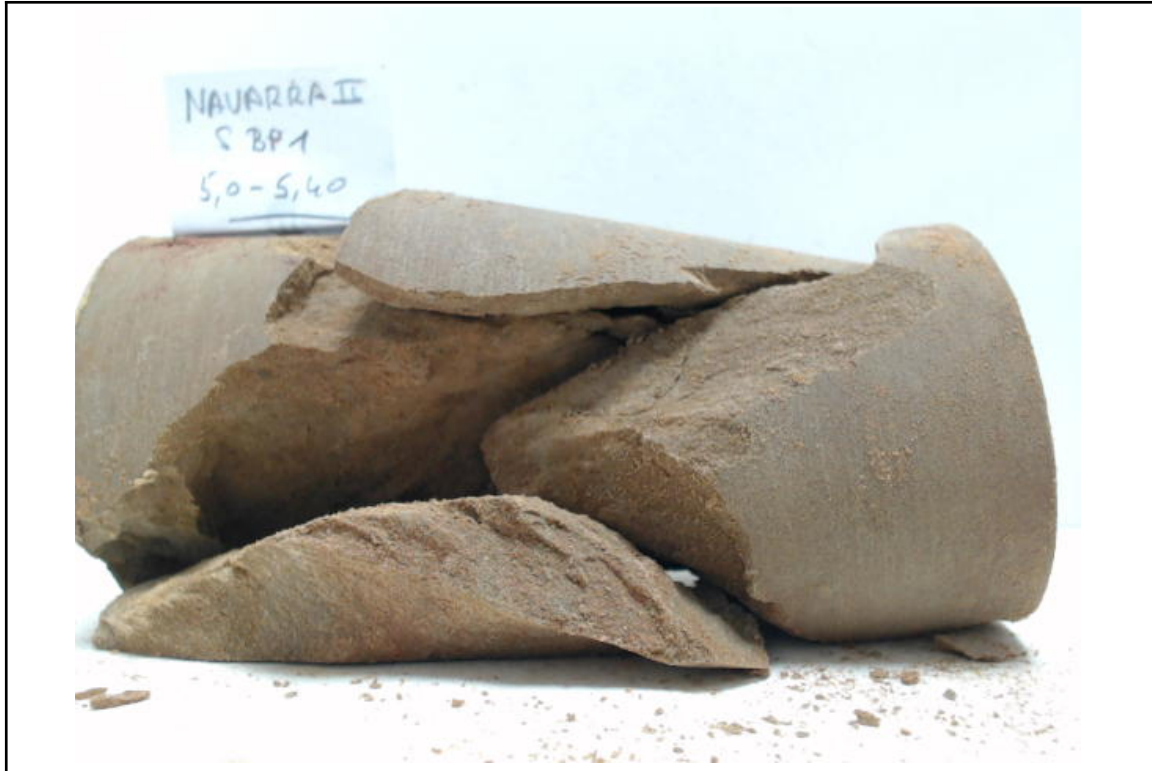
Probeta tras ensayo de compresión simple
