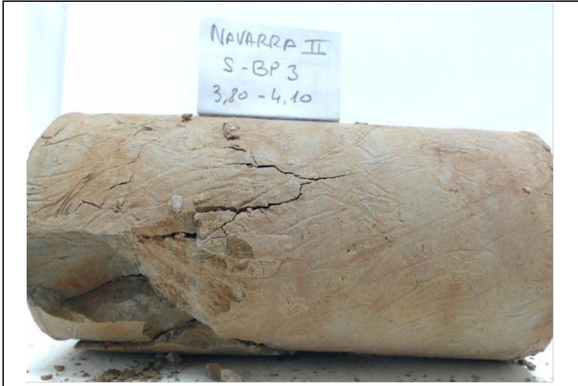
Probeta tras ensayo de compresión simple
