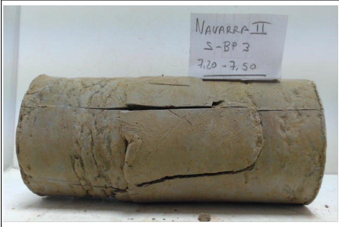
Probeta tras ensayo de compresión simple
