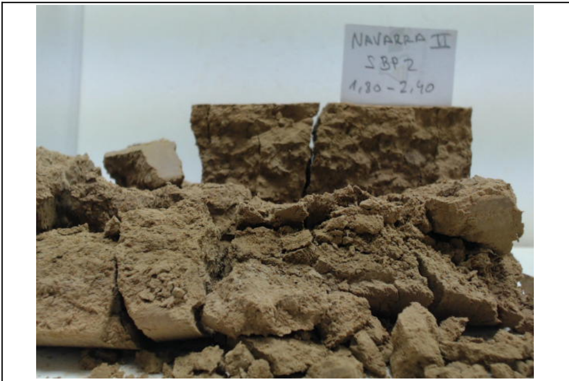
Fragmentos de la probeta tras la rotura
