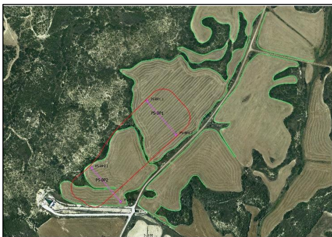
Perfiles sísmicos en la opción de emplazamiento de la balsa en el 2018
