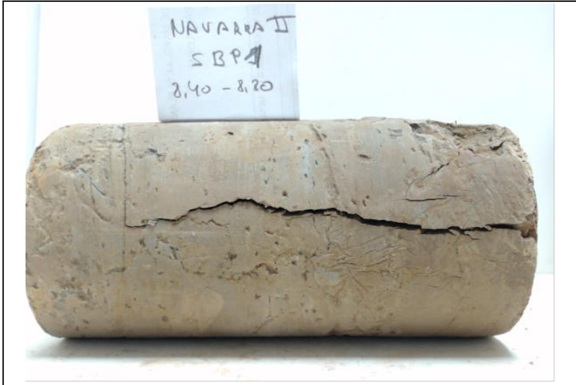
Probeta tras ensayo de compresión simple
