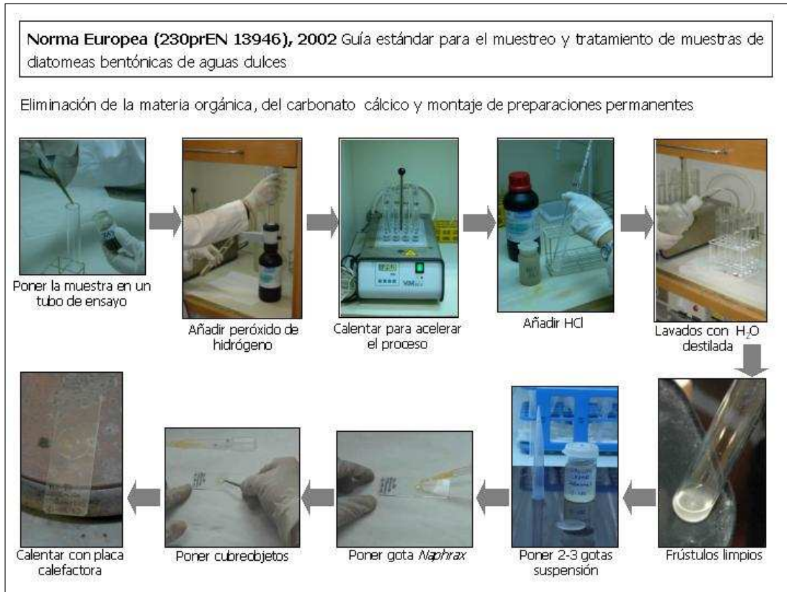
Figura 2. Protocolo tratamiento digestión de diatomeas y montaje de preparaciones microscópicas.
